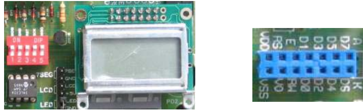
Şekil 6 LCD ve 24c32'nin bağlantısı
